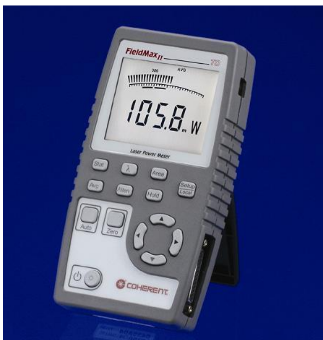
6. ábra. Coherent FieldMaxII-TO lézerteljesítmény mérőműszer [7].
